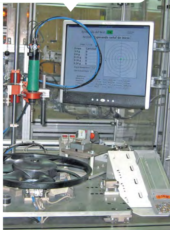
Ensayos de electroventiladores
